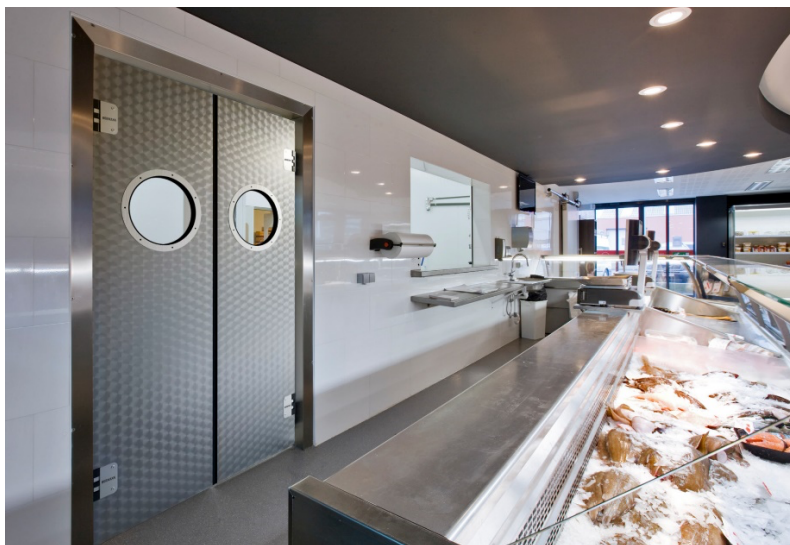
4.kép: A Hörmann rozsdamentes acél lengőajtóinak ajtólapjai 40 mm vastag habmaggal rendelkeznek. Kétféle designban érhetők el.
