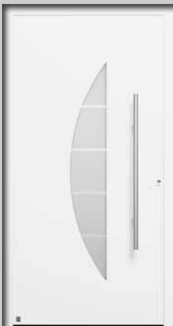
505 jelű motívum HOE 500 nemesacél fogantyú, motívumos üveg, mattolt Float 4 átlátszó sávval, 3-rétegű hővédő üveg, U_D -érték max. 0,9 \text{ W}/(\text{m}^2 \cdot \text{K})^*
