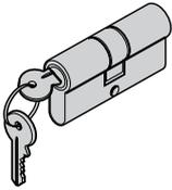
Der Profilzylinder ist die gebräuchlichste Form der heute verwendeten Sicherheitstürschlösser und eine Form des Schließzylinders. Der Profilzylinder ist nach DIN 18252/EN 1303 genormt und unabhängig vom Fabrikat austauschbar.
